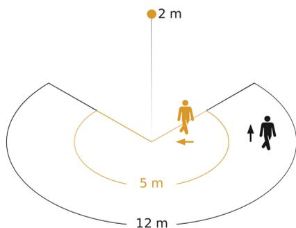
Possibile altezza di montaggio: 1,80 m - 6,00 m
